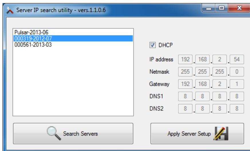
Il software Server Manager è installato insieme al software ThinKnx Configurator. Cerca nella rete tutti i server Alveo connessi e mostra le impostazioni di rete di ogni dispositivo.
