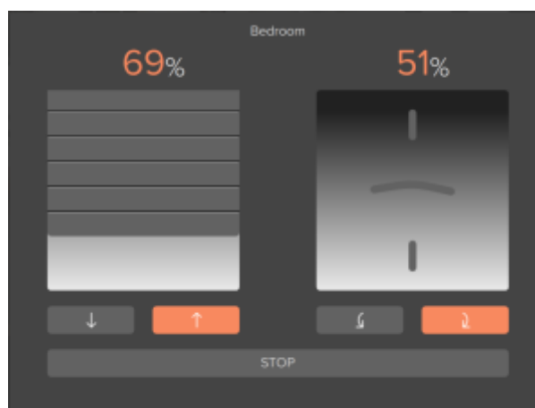
Figura 48: Comando Veneziana. I controlli permettono di regolare la posizione della veneziana e la rotazione delle lamelle.
