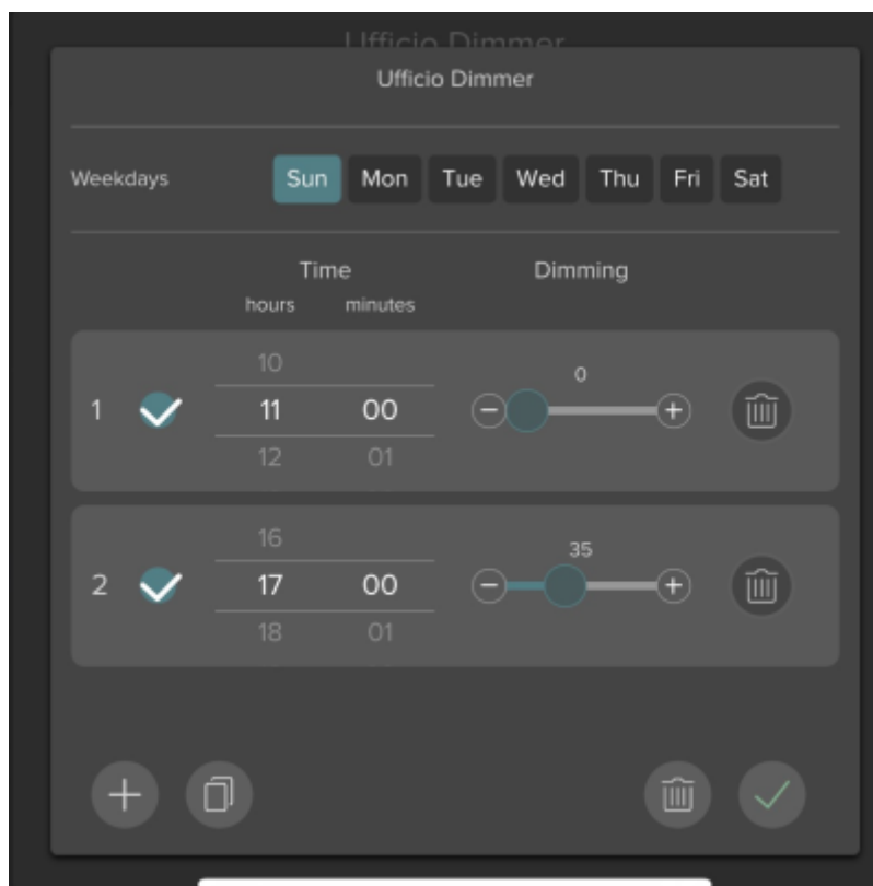
Figura 40: Programmazione del comando Dimmer. La finestra permette di impostare giorni, orari e valori di luminosità.
