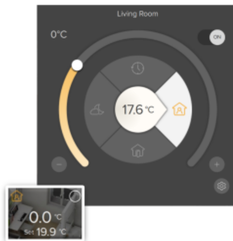
Figura 51: Thermo Comfort: Tipo 2. Il setpoint può essere gestito tramite le modalità Comfort, Standby, Notte e Antigelo.
