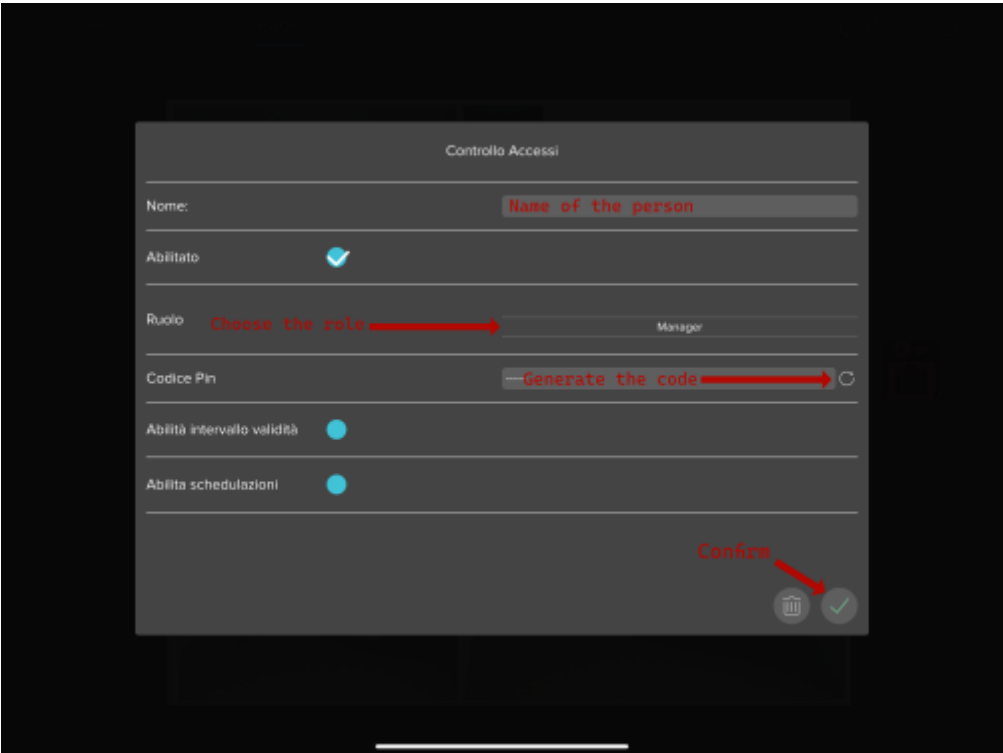
Figura 82: ViaVai: proprietà dell'utente. La finestra permette di impostare abilitazione, ruolo, PIN e limitazioni della credenziale.
