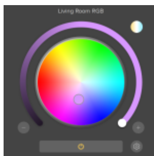
Figura 43: Comando RGB. La ruota colori e lo slider permettono di selezionare il colore e regolare la luminosità.
