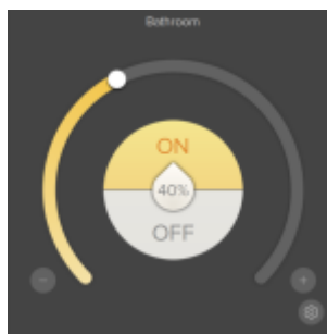
Figura 39: Comando Dimmer. Il popup permette di accendere o spegnere la luce e regolarne la luminosità.
