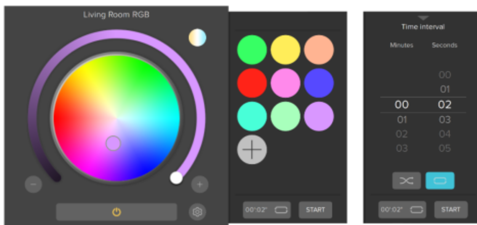
Figura 44: RGB: colori salvati e sequenza. La finestra permette di salvare colori e configurarne la riproduzione in sequenza.
