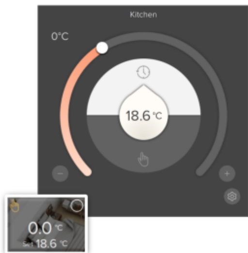
Figura 50: Thermo Comfort: Tipo 1. Il setpoint può essere regolato manualmente oppure tramite il cronotermostato.
